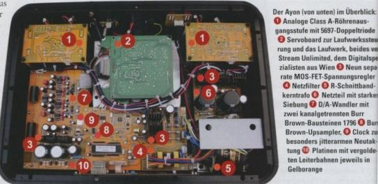
O Analoge Class A-Röhrenausgangsstufe mit 5697-Doppeltriode Servoboard zur Laufwerkssteu rung und das Laufwerk, beides vo Stream Unlimited, dem Digitalspe zialisten aus Wien 3 Neun separate MOS-FET-Spannungsregler O Netzfilter G R-Schnittbandkerntrafo (1) Netzteil mit starker Siebung O D/A-Wandler mit zwei kanalgetrennten Burr Brown-Bausteinen 1796 @ Burn Brown-Upsampler,
