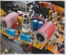
Die kanalgetrennten Ausgangsstufen sind gegenkopplungsfrei und mit 5687-Röhren bestückt
