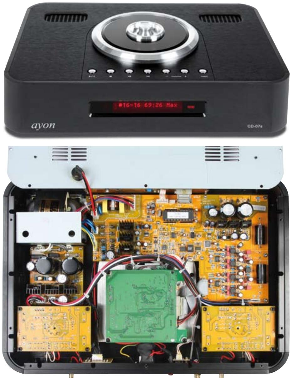
Hängender Schaltungsaufbau im Ayon: Die Röhren-Ausgangsstufen hausen auf eigenen Platinen (rechts und links unten). Das Toplader-Laufwerk stammt von Stream Unlimited aus Österreich.
