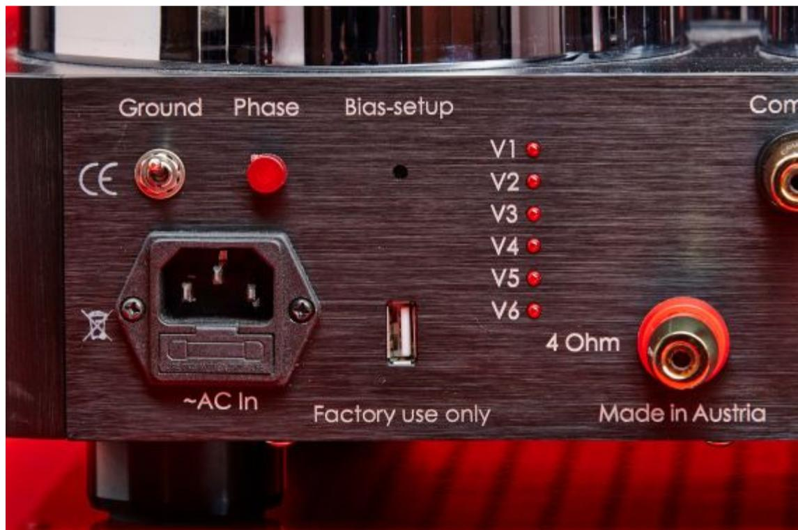
SOLANGE KEINE DIESER SECHS LEDS LEUCHTET, IST ALLES IN ORDNUNG: SIE SIGNALISIEREN, WELCHE RÖHRE BEI EINEM DEFEKT AUSGETAUSCHT WERDE MUSS. ÜBER DEN USB-ANSCHLUSS LASSEN SICH WICHTIGE EINSTELLUNG ÄNDERN. SO WÄRE MIT DEN SECHS KT150 EINE DEUTLICH HÖHERE LEISTUNG ALS 180 WATT ZU ERREICHEN
