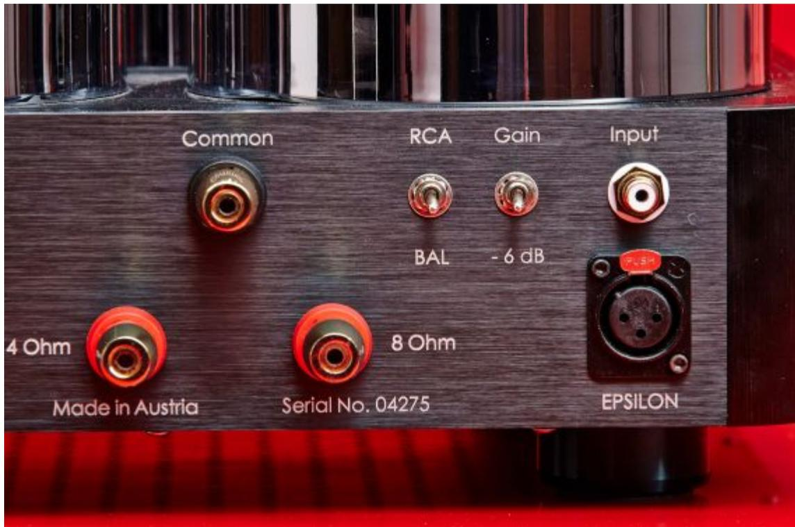
DA DIE EPSILON VOLLSYMMETRISCH AUFGEBAUT IST, MACHT HIER DIE VERKABELUNG ÜBER DIE XLR-VERBINDUNG DURCHAUSS SINN
