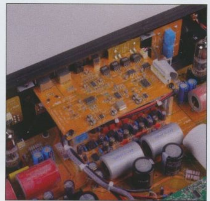
Das DAC-Board ist besonders lecker. Kanalgetrennte Wandlerchips, eigene Stromversorgung
