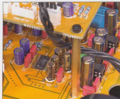
Das Digital Interface sitzt auf einer separaten Platine und ist austauschbar
