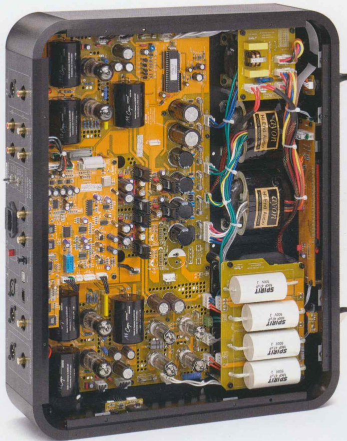
Die Stromversorgung ist Ayon-typisch aufwendig, sie nimmt ein gutes Drittel des Gehäusevolumens ein. Schön zu sehen: die CLC-Filterung am Netzeingang
