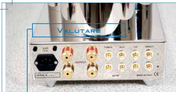
*Il pannello delle connessioni è parco ma di qualità. Sull'estrema destra è presente un ingresso Direct capace di bypassare il selettore degli ingressi.*
